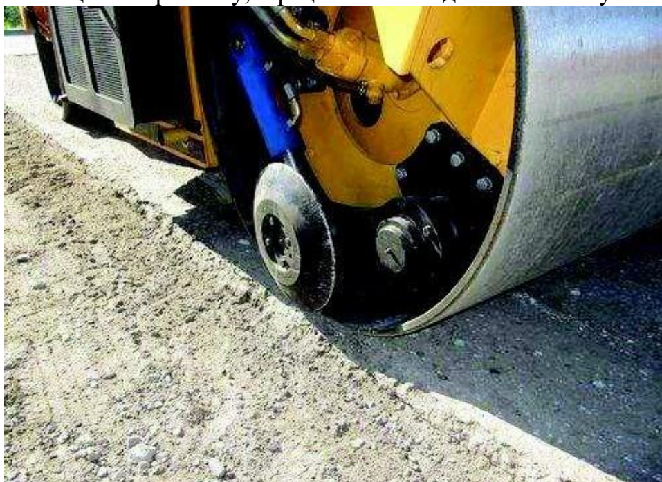
Сурет 1.4 – Асфальтбетон төсемдеріндегі жиектерді кесуге арналған жол катогының қосымша жабдығы
