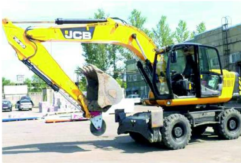
3.13 - сурет – JSB – 160W экскаваторындағы ОДН-550 дискілі пышақ жабдығы
