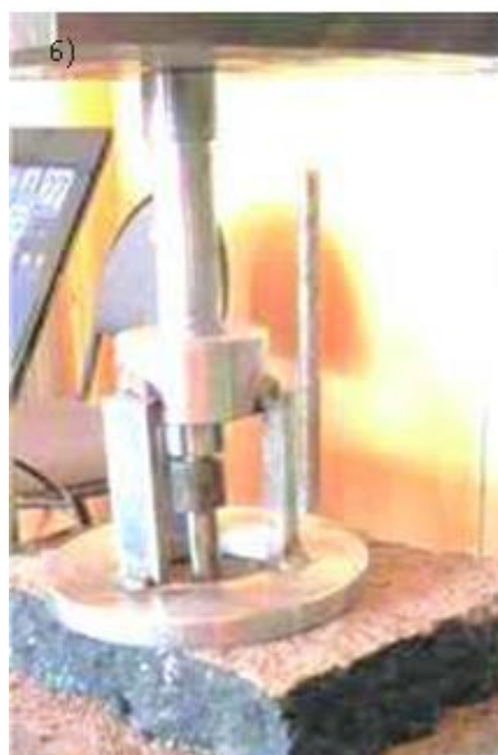
2.6 - сурет–Гидравликалық ұштықтардың конструкциясы (а) дөңгелек ұштықпен және желілік профильмен статикалық пенетрация схемасы (.), (b)
