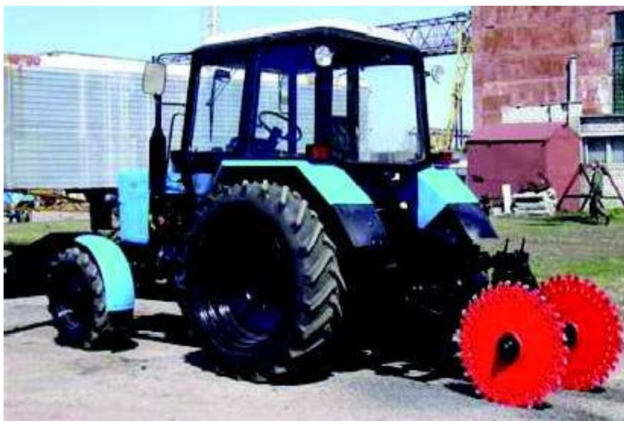
Сурет 1.2–Тізбекті экскаватор ЭТЦ–1609 үшін ауыстырылатын фрезерлік жұмыс органы АНД-25
