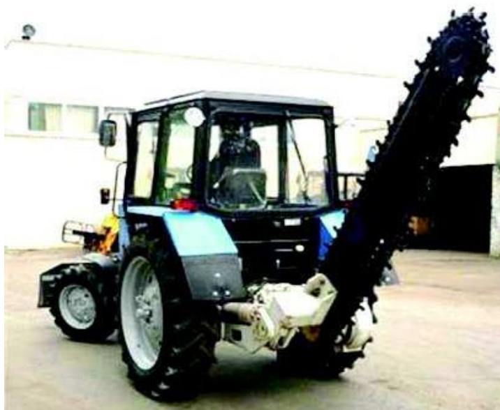
1.1 – сурет - Дмитров экскаватор зауытының ЭТЦ-201 шынжырлы траншеялы экскаваторы
