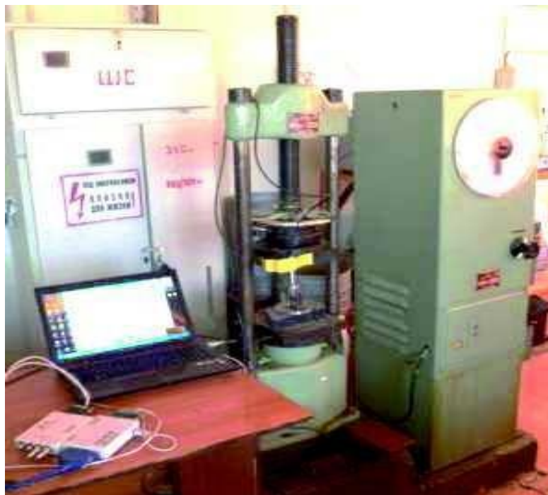
2.5 - сурет – Асфальтбетонның беріктік қасиеттерін бағалауға арналған зертханалық кешен
