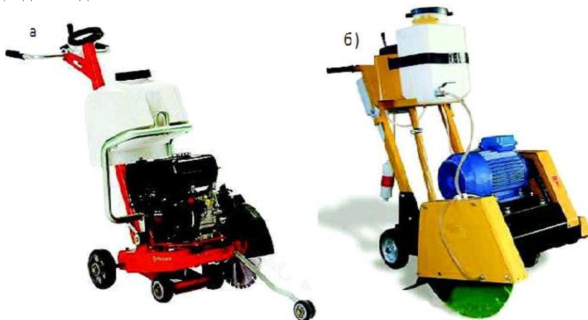
а –Husqvarna FS – 350 моделі, б –Сплитстоун CS–189 моделі электрлі қозғалтқышпен
