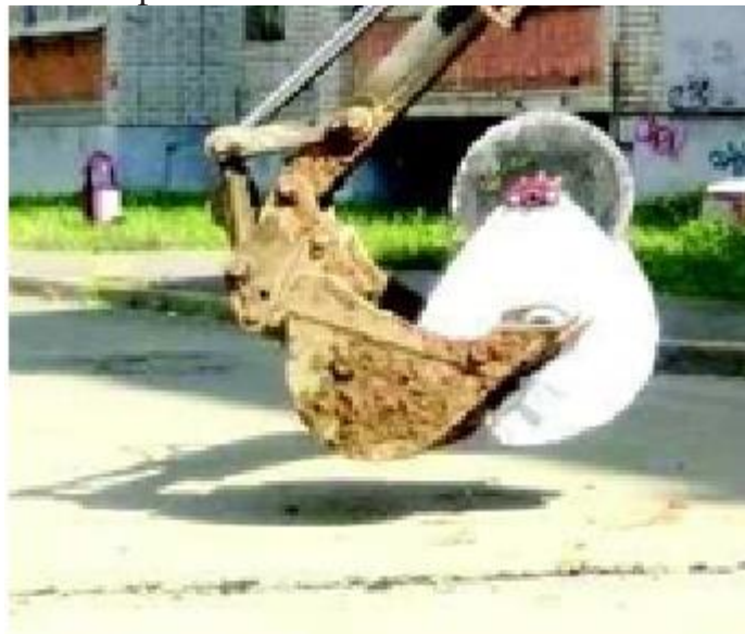
3.15 - сурет - КДН – 500 модельдерінің дискілі пышағын шөмішке бекіту
