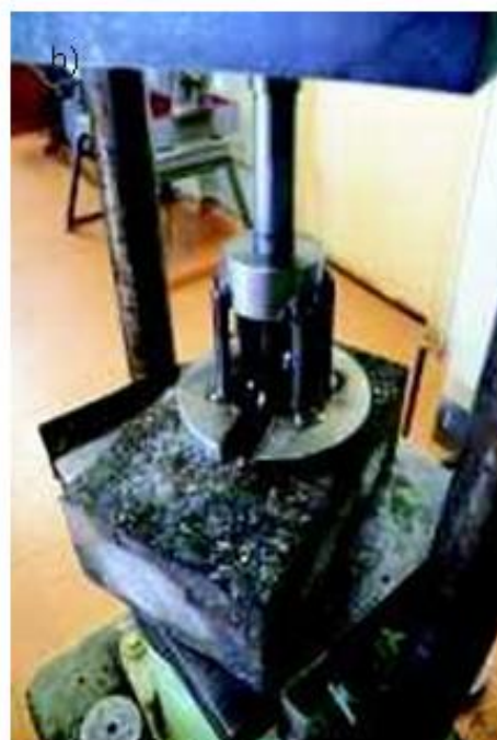
2.6 - сурет–Гидравликалық ұштықтардың конструкциясы (а) дөңгелек ұштықпен және желілік профильмен статикалық пенетрация схемасы (.), (b)
